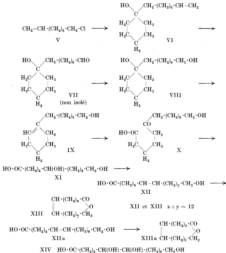
L'alcool undécylénique est transformé en chlor-11-undécène-1 (V) par la méthode de *Darzens*<sup>4)</sup>. L'action de la cyclohexanone sur l'organomagnésien du chlorure V conduit à l'undécényl-cyclohexanol VI.
